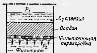
Рис. 3.10. Схема процесса фильтрации
