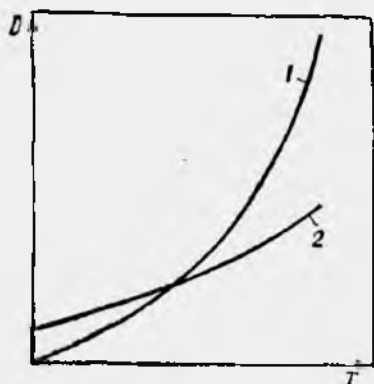
Рис. 16.2. Зависимость константы скорости реакции k (1) и коэффициента диффузии D (2) от температуры
