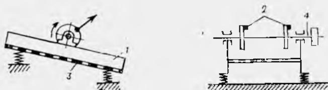
Рис. 19.5. Схема вибрационного грохота:
