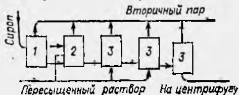
Рис. 15.4. Вакуум-кристаллизатор непрерывного действия: 1—3 — стадии (ступени)
