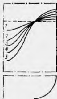
Рис. 4.3 Глубина и форма воронки, возникающей в аппарате с D_{\text{ап}} = 300 мм при перемешивании воды лопастной мешалкой ( \alpha = 45^\circ ) диаметром d_M = 200 мм, расположенной от дна на высоте h_M = 0,75d_M при разных частотах вращения n (в об/с): 1—1,7; 2—2,5; 3—2,9; 4—3,3; 5—3,7
